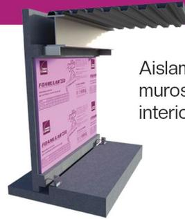
Aislamiento térmico para muros de fachada, aplicación interior o exterior.
