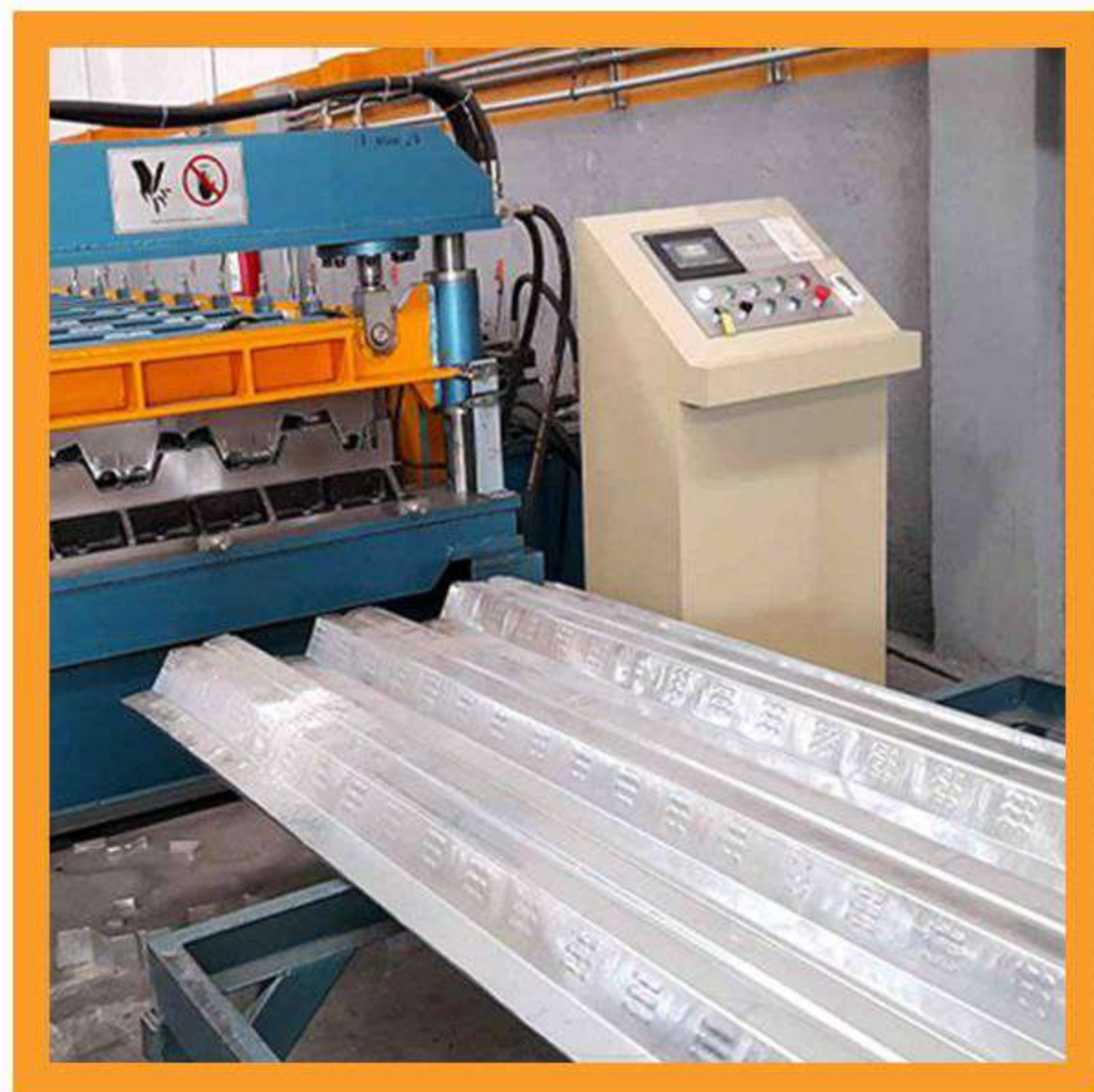
ACANALADO DE LÁMINA LOSACERO 25
