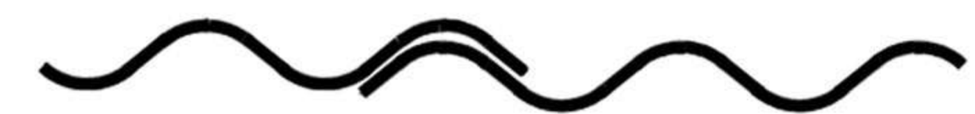
Traslape longitudinal muros
